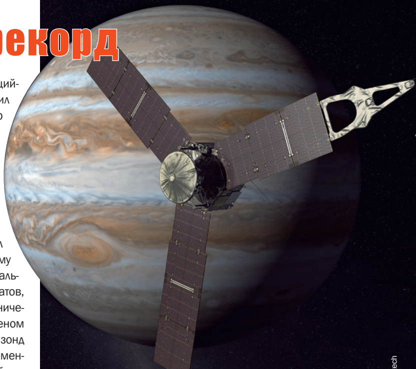
Космический аппарат Juno, стартовавший в 2011 г., прибывает в окрестности Юпитера в 2016 г. для изучения гигантской планеты с эллиптической полярной орбиты. Он осуществит многократные проходы между планетой и ее мощными внутренними радиационными поясами на высоте около 5000 км над верхней кромкой облачного покрова.
